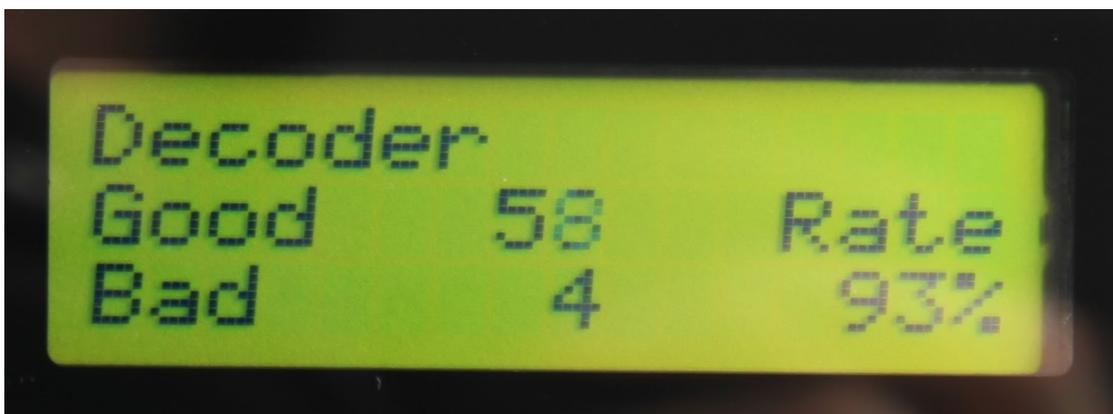
Die '**Decoder**' Seite zeigt uns wieviele Telemetriepakete empfangen wurden sowie die Fehlerrate. Dies zeigt nicht die Qualität der Telemetriedaten selbst sondern nur die Güte der Übertragung.
