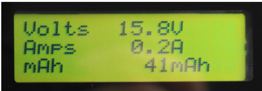
Auf der **'Volts'** Seite sehen wir die Spannung des Flugakku im Modell, die aktuell benötigte Stromstärke in Ampere und die Kapazität in mAh welche bereits verbraucht wurde. Dies wird nur angezeigt, wenn das Modell mit einem Stromsensor ausgestattet ist.
