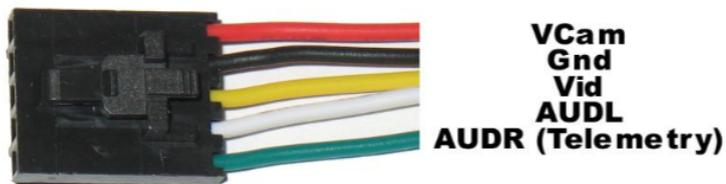
Es befindet sich ein zusätzlicher Konnektor auf der Platine der ImmersionRC/Fatshark Sender für zukünftige Erweiterungen. Es ist ein 5-pin JST (kleiner, weißer Stecker), mit der selben Pin-Belegung wie der größere 5-Pin Molex. TinyTelemetry schließt man direkt an diesen Anschluß an.
