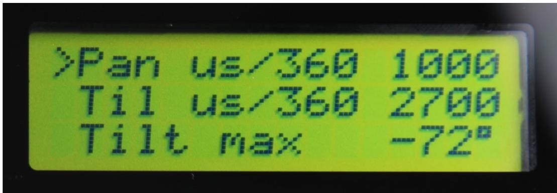
**Pan us/360, Til(t) us/360:** Hier wird das Verhältnis zwischen Winkel und Servoweg definiert. Das braucht nur einmal eingestellt werden, wenn Sie die Antennenhalterung einstellen. Sehen Sie hierzu den Punkt 'Einstellung der Servos' im Handbuch für eine genaue Erklärung bzw. Beispiele zu gängigen Servos.
