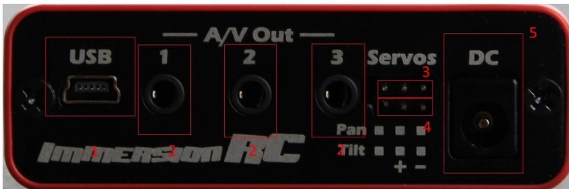
1. USB Anschluß: verwendet für Firmware Aktualisierung, wird im Normalbetrieb nicht benötigt
