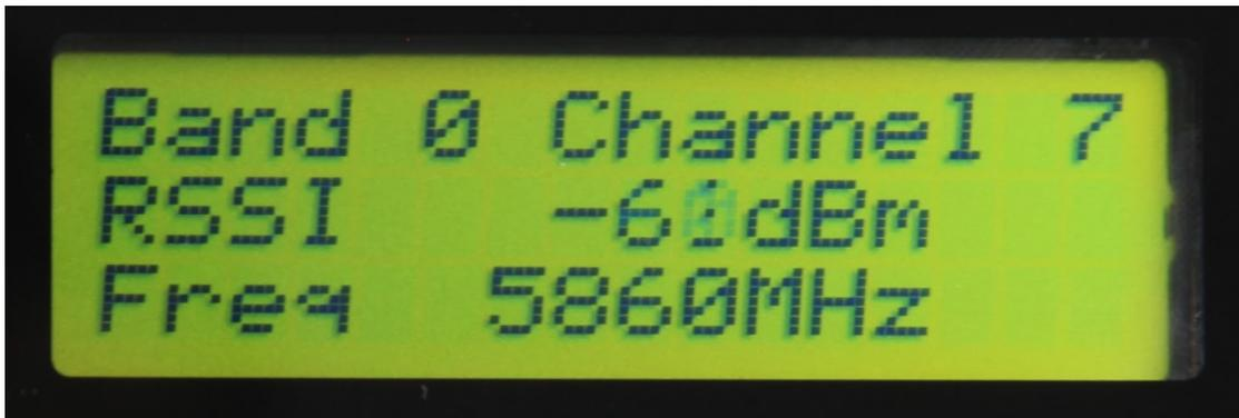
Die **Receiver** Seite zeigt die Information über die A/V Verbindung. Es wird Band, Kanal und Frequenz sowie RSSI Wert des empfangenen Signales angezeigt.
