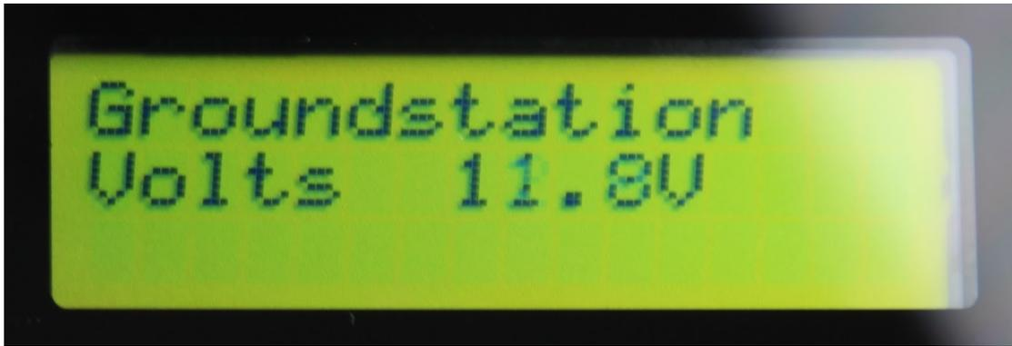
Auf der **Groundstation** Seite sehen Sie die Spannung des Akkus der die Bodenstation versorgt.
