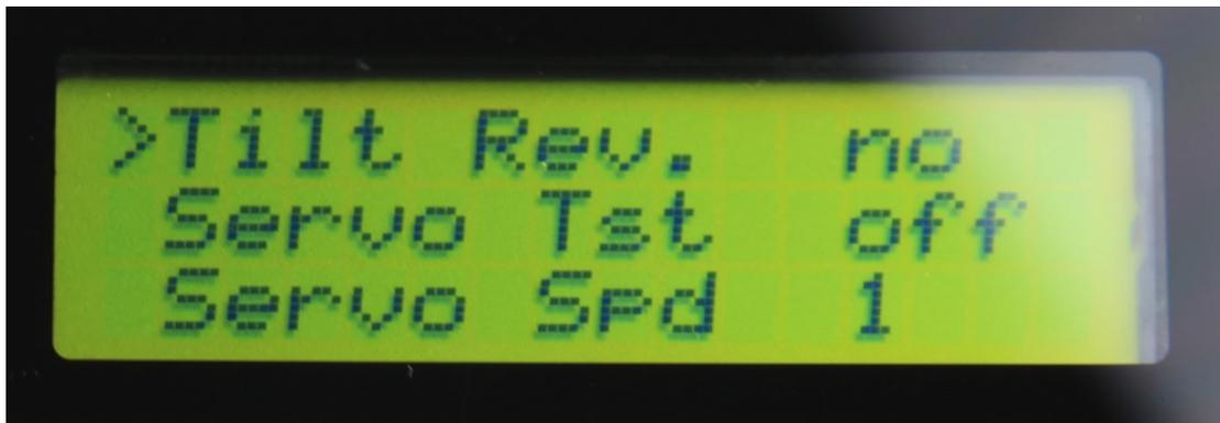
**Pan Rev(erse), Tilt Rev(erse):** Ermöglicht die Umkehr von Schwenk- oder Neigeservo um verschiedene Servotypen verwenden zu können.
