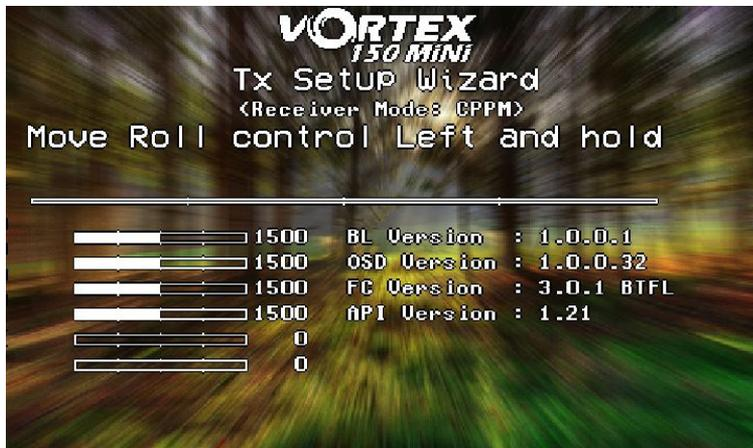
Segui i passi, assicurandoti che lo stick giusto sia mosso ogni volta. Non appena un controllo è riconosciuto il suo nome apparirà a sinistra della barra del servo.
