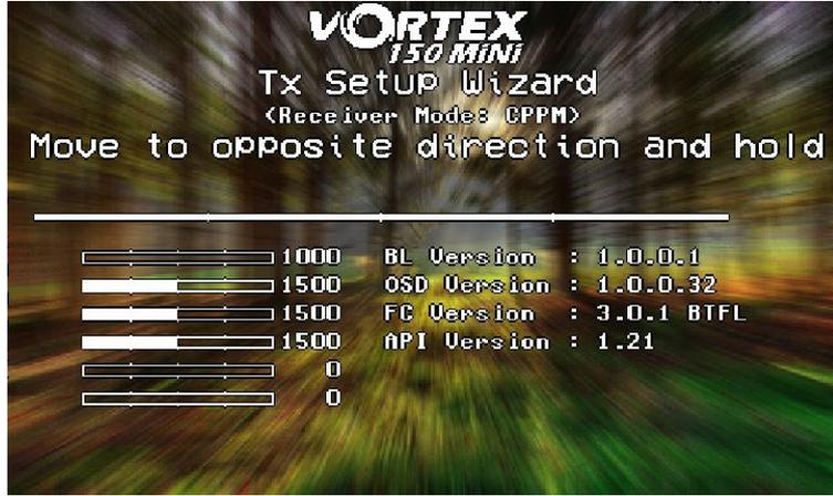
Una volta che i quattro principali controlli sono memorizzati, metti il quad su una superficie piatta e livellata e muovi lo stick destro indietro. Questo farà eseguire la calibrazione degli accelerometri.
