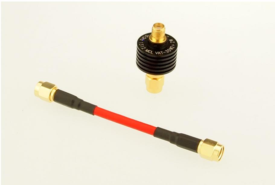
**SUGERENCIA:** Los conectores SMA son fácilmente dañables debido a las repetidas conexiones/desconexiones, es recomendable conectar el atenuador directamente al medidor de potencia y usar el adaptador SMA conectado a la fuente de emisión de RF. El adaptador siempre será más económico de reemplazar que el atenuador, en el caso de que el conector se llegara a dañar.
