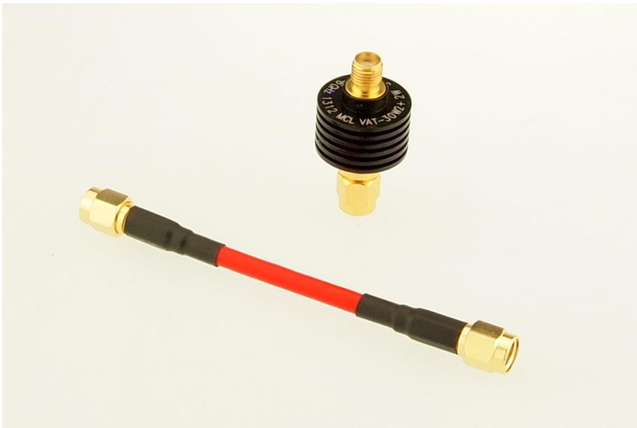
TIP: Da SMA-Anschlüsse leicht durch das wiederholte An- und Abstecken beschädigt werden, ist es empfehlenswert, das Dämpfungsglied direkt auf den Power Meter anzuschließen und danach das Adapterkabel. Falls der Stecker des Kabels beschädigt wird, ist dieses deutlich günstiger zu ersetzen als das Dämpfungsglied!
