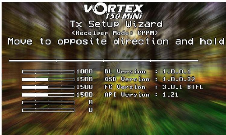
Une fois que les quatre commandes principales sont entrées, placez votre quadcoptère sur une surface plane et de niveau et tirez sur le manche droit. Cela calibrera l'accéléromètre.
